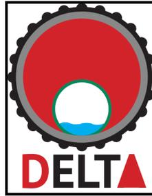
Der VPC DELTA Ring besteht aus einem äußerst widerstandsfähigen Elastomere-Material und besitzt - je nach Größe bzw. Anwendungsfall - eine statische Aussteifung. Der Ring ist in der VPC-Kupplung **verliersicher eingelegt** und lässt sich dort **um 360° drehen**.
