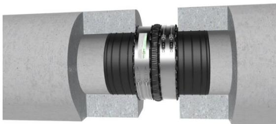
**Pos: ... VPC I/I (Innen/Innen) Rohr-Adapter – flex bis 2,5 bar dicht** für einen stufenlos anpassbaren, scherlastsicheren Innenanschluss von Rohren mit innerem Kreisprofil und/oder mit außen nicht kreisförmiger Rohrgeometrie (z.B. Fuß- oder Atlasrohre) auf runde Rohre aus verschiedenen Werkstoffen in Kombination mit der im Lieferumfang enthaltenen VPC Rohrkupplung.
