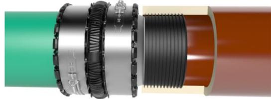
**Pos: ...** VPC I/A (Innen-Außen) Rohr-Adapter – starr für einen tragfähigen, scherlastsicheren Übergang von Rohren mit innerem Kreisprofil und/oder außen nicht kreisförmiger Rohrgeometrie (z.B. Fuß- oder Atlasrohre) auf runde Rohre aus verschiedenen Werkstoffen in Kombination mit der im Lieferumfang enthaltenen VPC Rohrkupplung.
