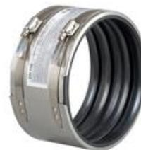
**Pos:...** V-KON Rohrmanschette bis 2,5 bar dicht, für eine scherlastsichere Verbindung von Abwasserleitungen (z.B. Steinzeug etc.) - gem. Anforderungen DIN 460 - mit annähernd gleichen Außendurchmessern und/oder aus verschiedenen Werkstoffen. Bestehend aus zwei gegeneinander geführten Halbschalen welche durch kraftschlüssig angebundene Spanngurte gegeneinander konisch reduzierbar sind, incl. Dichtungskörper aus EPDM DIN EN 681-1 mit mehrfachem Doppeldichtprofil.
