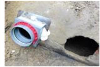
**Pos: ...** VPS Rep-Abzweig 90° *interaktiv* für die Sanierung von ausgebrochenen Öffnungen an dünn- bzw. dickwandigen Kanalrohren in den Nennweiten von 300 – 2800 mm. Bestehend aus dem multifunktionalen VPS Seitenanschluss, einer anschmiegbaren Innenrosette und einem anpassbaren Sattelblech aus Edelstahl für eine **automatische**, stufenlose Anpassung an den jeweiligen inneren bzw. äußeren Rohrradius für eine kraftschlüssige Anbindung.
