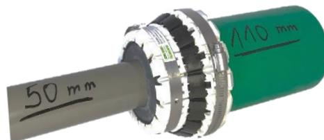
**Pos:...** Vario-Pipe-Drehgelenk-Kupplung bis 2,5 bar dicht, für eine stufenlos anpassbare, scherlastsichere Verbindung von allen Abwasserleitungen - gem. Anforderungen DIN 460 - mit unterschiedlichen oder auch gleichen Außendurchmessern und/oder aus verschiedenen Werkstoffen.
