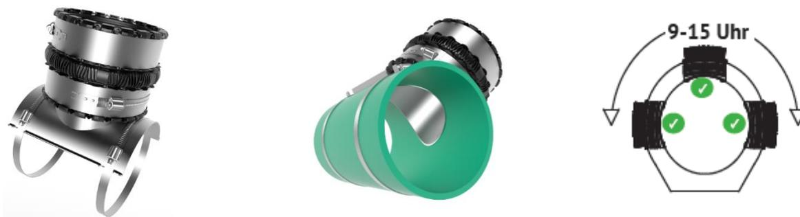
**Pos: ...** Vario-Sattelschelle 90° für den nachträglichen, scherlastsicheren, dichten Anschluss an **dünn- bzw. dickwandige** Kanal-Hauptleitungen mit glatter Außenoberfläche. Sattelschelle und Spanngurte aus nichtrostendem Edelstahl incl. variabler VPC Anschlussmuffe.
