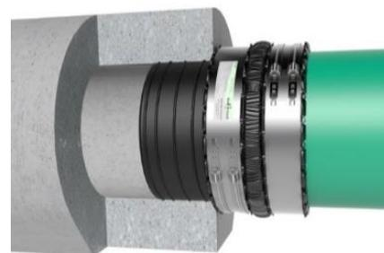
**Pos: ... VPC I/A (Innen-Außen) Rohr-Adapter – flex bis 2,5 bar dicht** für einen stufenlos anpassbaren, scherlastsicheren Innenanschluss von Rohren mit innerem Kreisprofil und/oder mit außen nicht kreisförmiger Rohrgeometrie (z.B. Fuß- oder Atlasrohre) auf runde Rohre aus verschiedenen Werkstoffen in Kombination mit der im Lieferumfang enthaltenen VPC Rohrkupplung.
